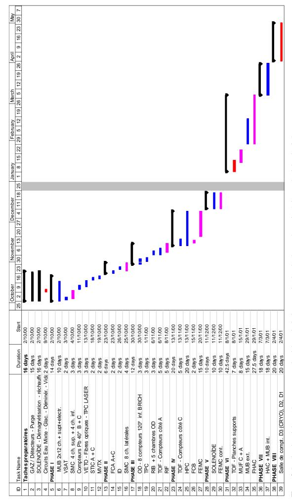
Figure 3. Le planning ci-dessus donne un aperçu des tâches principales, reparties dans la phase préparatoire (mise en sécurité) et les 8 phases correspondant au démontage. Il ne laisse pas apparaître les tâches annexes nécessaires au dégagement et l'évacuation des éléments démontés (échafaudages, sectionnement des câblages et tuyauteries, etc.).
